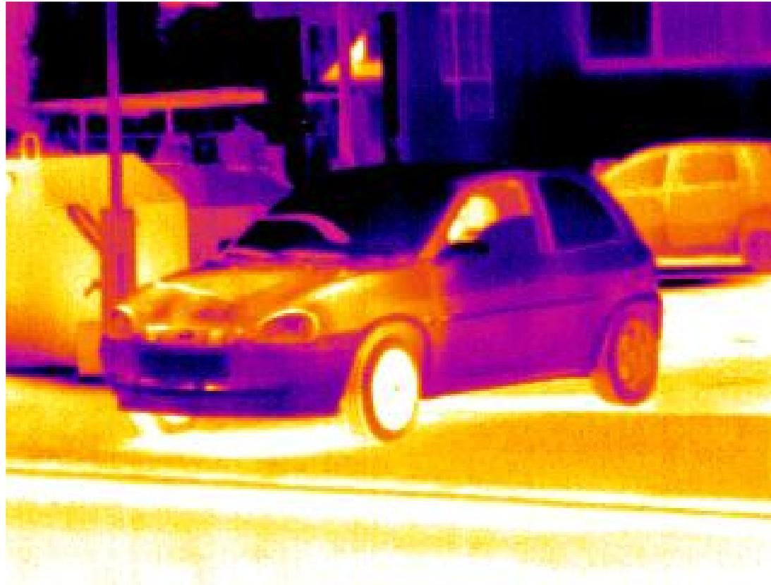
Abbildung 6: Mal ne Quizfrage: Vorder- oder Hinterrad-Antrieb? Die Frage lässt sich im Wärmebild leicht beantworten ...
