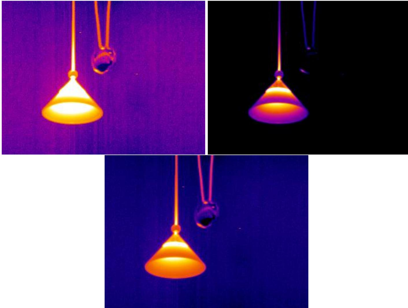
Abbildung 3: Lampe mit Verzierung in unterschiedlicher Skalierung; im unteren Bild kann man die Thermik von der heißen Lampe erkennen
